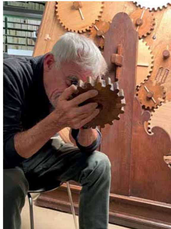
Dendrochronologische Messung eines Zahnrades aus dem Planetengetriebe des Bücherrads
